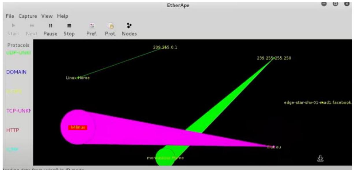
Sur cette capture d'écran, on voit bien que l'activité principale détectée par EtherApe (logiciel qui permet de surveiller un réseau informatique. Ce logiciel est muni d'une interface graphique qui permet de visualiser ce qui se passe sur un réseau) est majoritairement causé par des requêtes venant de Kali Linux.
